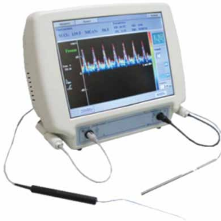
Figura 1. Monitor y Sondas de Micro Doppler Vascular (Micro Doppler Hadeco DVM 4500 Bidireccional) Utilizados en nuestro estudio para ultrasonografía intraoperatoria.
